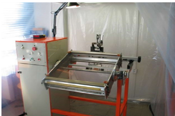
Obr. 6.8 Výroba IROC detektorov na FMFI UK v Bratislave, vľavo navíjacia aparátúra, vpravo zariadenie na skladanie IROC detektorov
