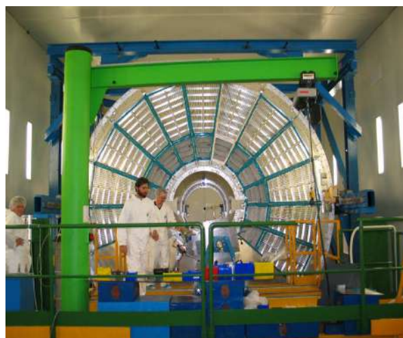
Obr. 6.10 Inštalácia IROC komôr do TPC ALICE v CERN-e. V popredí M. Šiška
