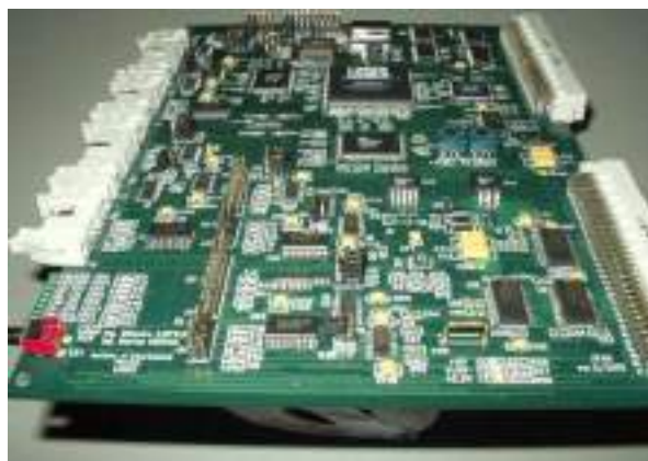
Obr. 6.12 JTAG kontrolér slúžiaci na konfigurovanie jednotlivých pixelových čipov SPD
