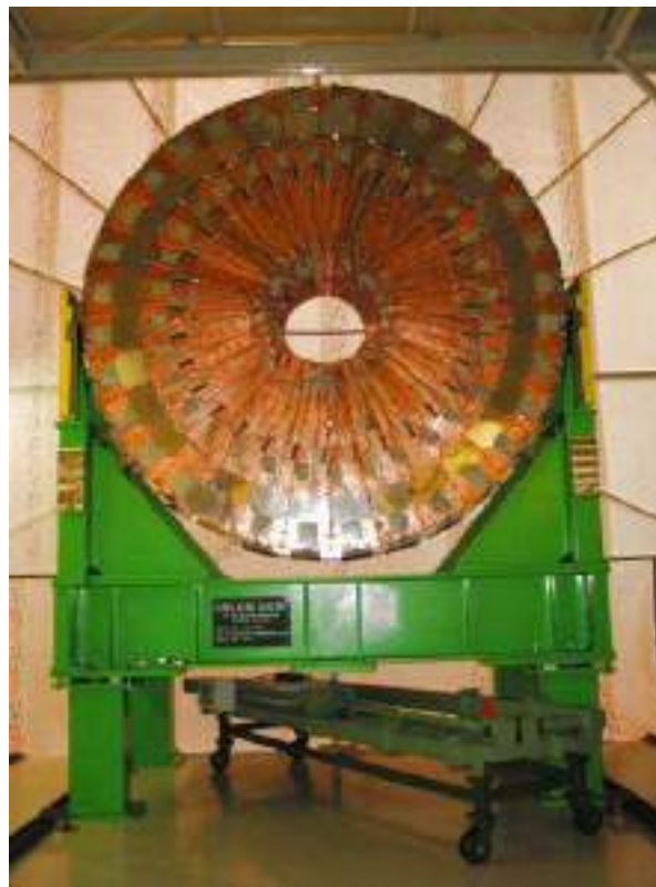
Obr. 5.4 Hadrónový End-Cap kalorimeter (HEC)
