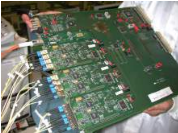
Obr. 6.11 Jeden VME modul (veľkosti 9U) smerovača pre kremíkový pixelový detektor
