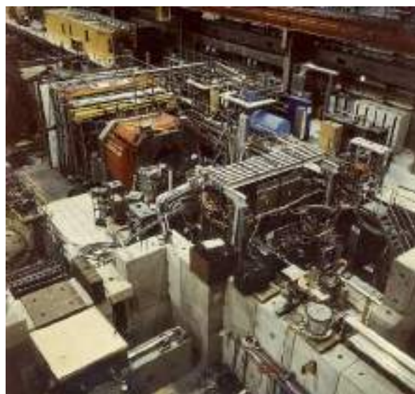
Obr. 8.1 Pohľad na detektory experimentu NA34 – HELIOS v severnej experimentálnej hale SPS v CERN-e. Na ľavej strane fotografie je miónový spektrometer, ktorý v modifikovanej verzii bol hlavným detektorom experimentu HELIOS/3
