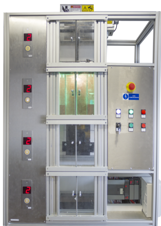
Obr. 11: Modelová aplikácia Výťah ( http://kyb.fei.tuke.sk/laboratoria/modely/vytah.php )
