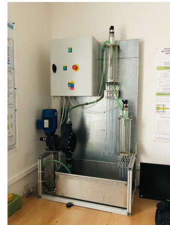
Obr. 16: Modelová aplikácia hydraulického systému (MAHS) ( http://kyb.fei.tuke.sk/laboratoria/modely/hyd.php )
