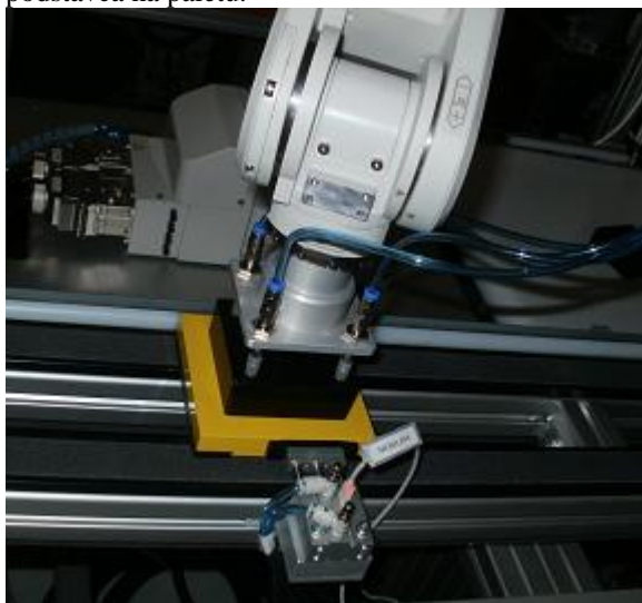
Obr. 15: Uloženie podstavca na paletu
