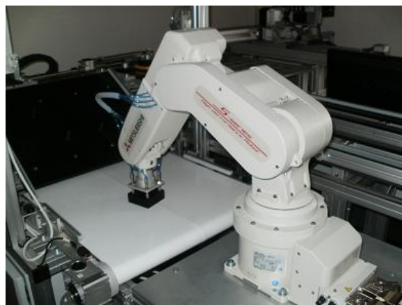
Obr. 9: Prebratie podstavca z pásu prvého postu
